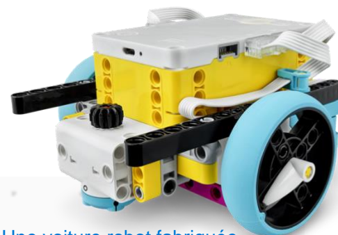
Une voiture robot fabriquée avec la trousse LEGO SPIKE Principal
